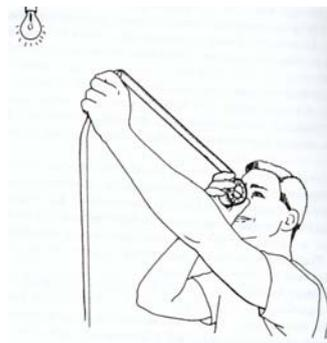
Charger avec cette bobine un magasin (dans le noir bien sûr) et après l'avoir identifié charger la caméra avec ce magasin. Faire tourner la caméra pour laisser défiler entre 50cm et un mètre de film, décharger la camera, placer le magasin au noir et couper dans la partie réceptrice le film passé, le mettre de côté. Ce test se fait sur tous les chargeurs (magasins avec presseur dorsal) et magasins.
